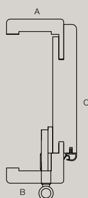
A: Decorative edge B: Rebate cladding C: Jamb lining
